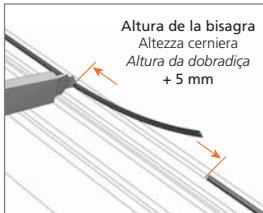
Recortar junta de la hoja en toda la altura de la bisagra.
